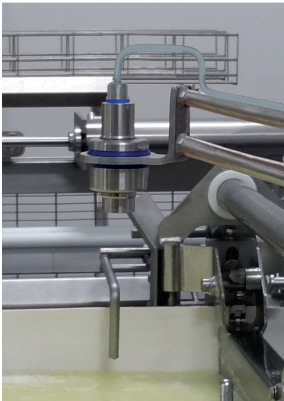
Füllstandsmessung bei der Käseherstellung
