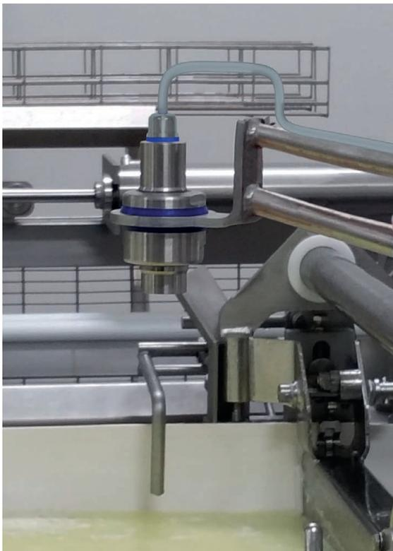
Füllstandsmessung bei der Käseherstellung
